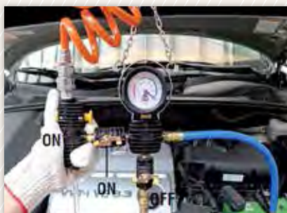
Zestaw Vacuum Coolant Refiller pracuje w zakresie od 0 do 8 bar
