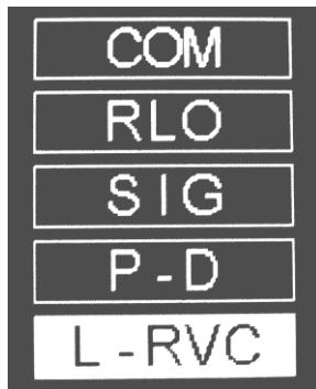
Okretanjem ručice izaberite funkciju L-RVC i potverdite kratkim pristiskom na ručicu. Uređaj će preći u režim testiranja L-RVC.
